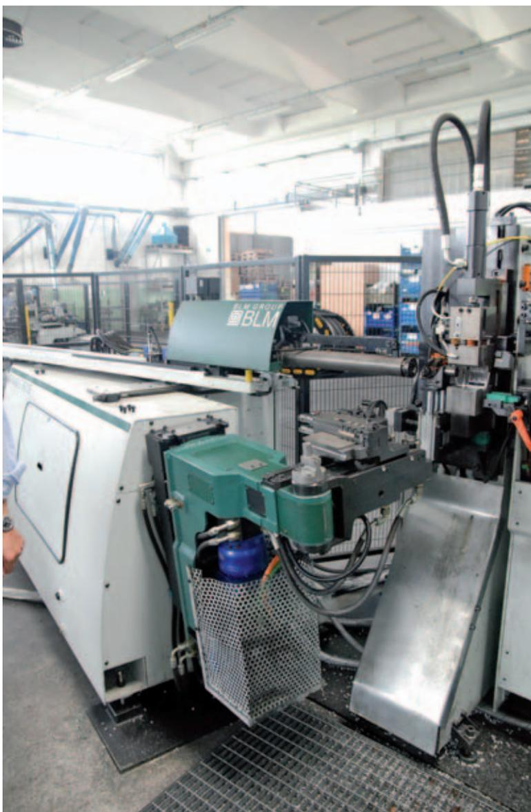
Una delle numerose curvatubi BLM installate in Mecart.
