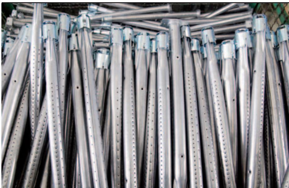
Alcuni bruciatori per forno realizzati da Mecart.
