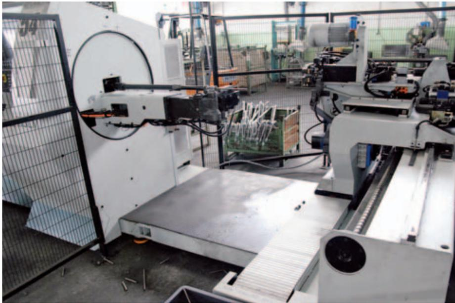
Idraulica o ibrida, *stand alone* o inserita in una delle cinque isole robotizzate installate in officina, la curvatubi costituisce comunque l'asse portante dell'attività di Mecart.
